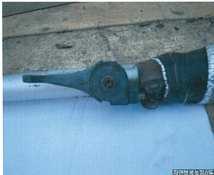
가속 손잡이(카브레타와 연결되어 연료의 양을 조절하는 것)를 조금 돌린 후 시동을 걸면 됩니다.
