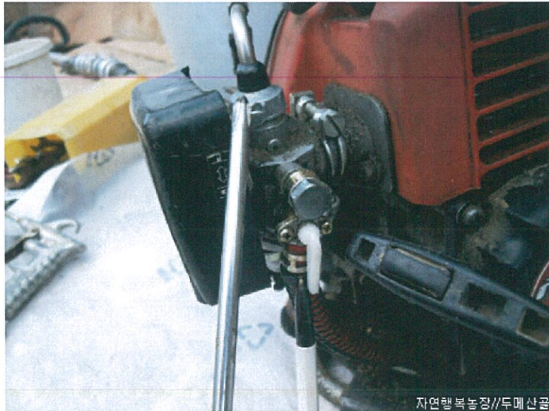
조립이 끝났으면 연료를 넣고, 연료 손잡이(하얀색)를 열고, 드라이버 일부분을 위로(↑) 올리고, <시동이 잘 걸리면 내려서 사용합니다(↓)>
